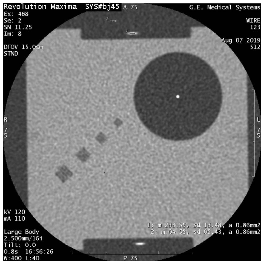
Figura 10-8 Coloque as duas ROIs para medir o número de TC do fio e do plano de fundo
