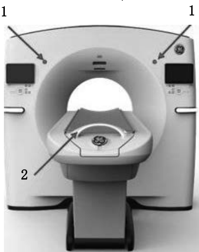
Figura 3-50 Botões de parada de emergência à frente do gantry
